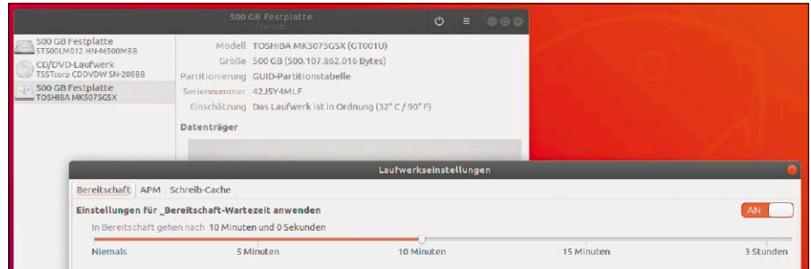
Datenfestplatten in den Ruhemodus schicken: Gnome-Disks beherrscht diese Aufgabe, notfalls ist dies aber auch über hdparm im Terminal zu steuern.
